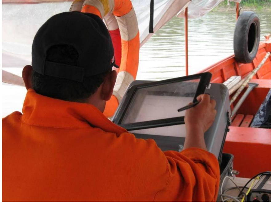
Fotografía 09.- Ecosonda empleada en los trabajos de batimetría
