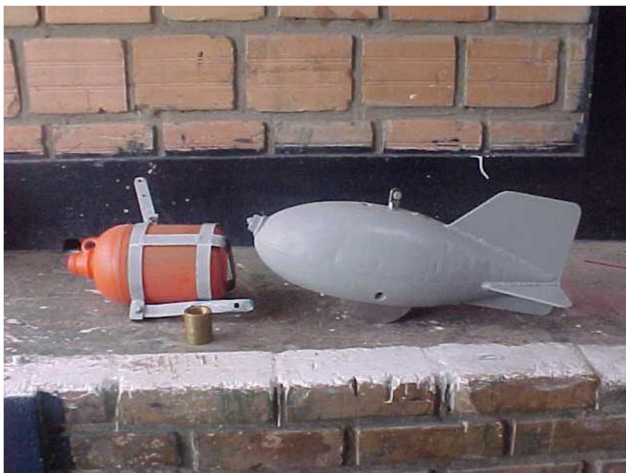
Fotografía 14.- Muestreador de sedimentos en suspensión
