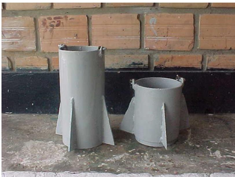
Fotografía 15.- Muestreador de sedimentos de fondo
