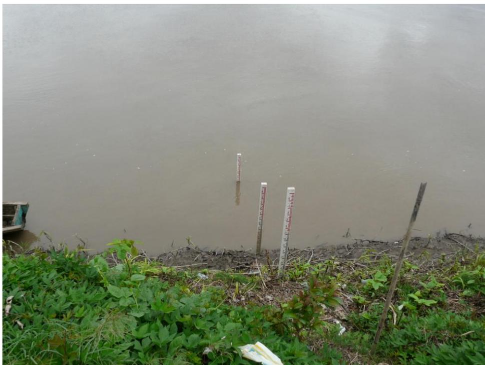
Fotografía 07.- Reglas limnimétricas instaladas en el poblado Caco
