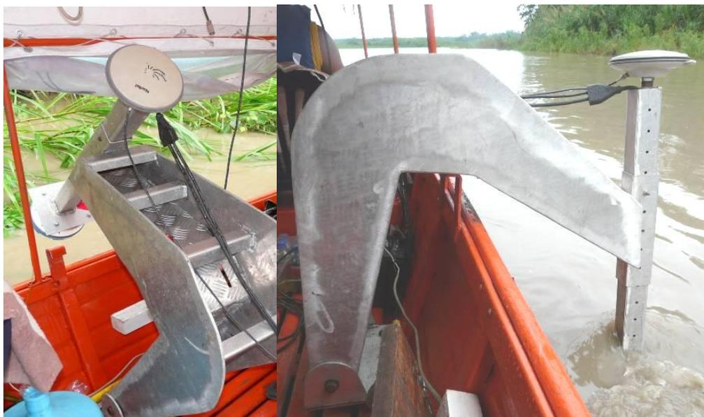
Fotografía 12.- El equipo ADCP y el DGPS en el brazo basculante
