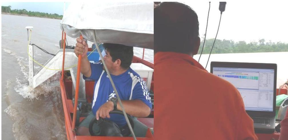
Fotografía 13.- Efectuando un aforo con el ADCP
