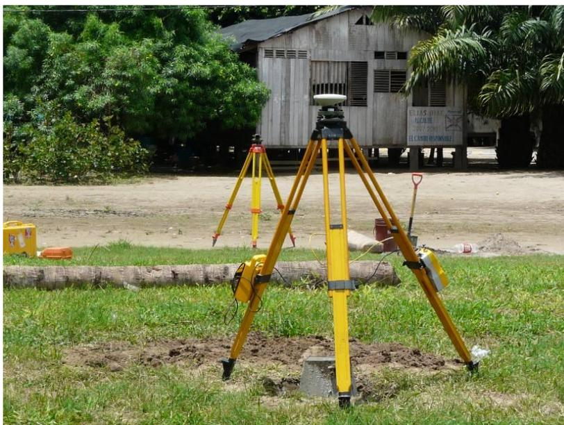
Fotografía 05.- Receptor remoto sobre hito geodésico en el poblado Caco
